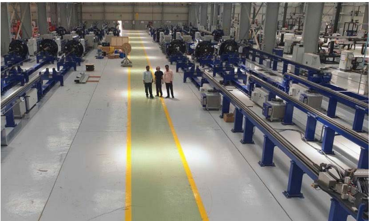
Рис. 2: Производственный цех с установками для 12-ти метровой горизонтальной наплавки TWIN-TIG er
