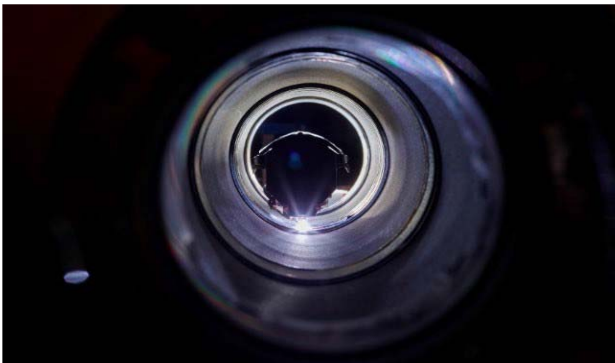
Рис. 1: Насадка для технологии наплавки TIG er
